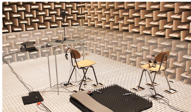
Abbildung 4.1.: Versuchsaufbau im reflexionsarmen Raum mit zwei Plätzen für zwei Musiker und den extra-auralen Kopfhörern. Im Hintergrund der Anordnung befindet sich der Kunstkopf.
