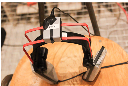
Abbildung F.4.: Extra-aurale Kopfhörer AKG K1000 mit angebautem Headtracker.
