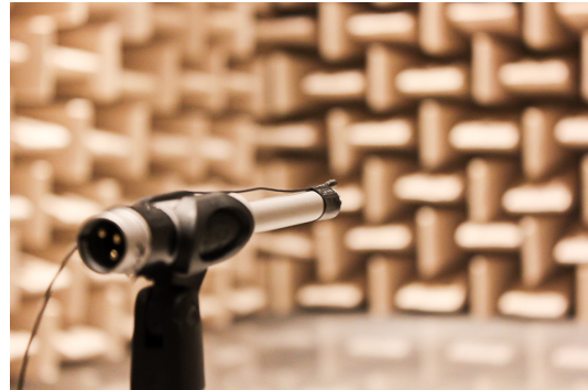
(b) Normalmikrofon Behringer ECM-8000 mit befestigtem DUT Sennheiser MKE 1.
